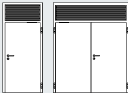
С вентиляционной решеткой (только двери многоцелевого назначения STS / STU)
